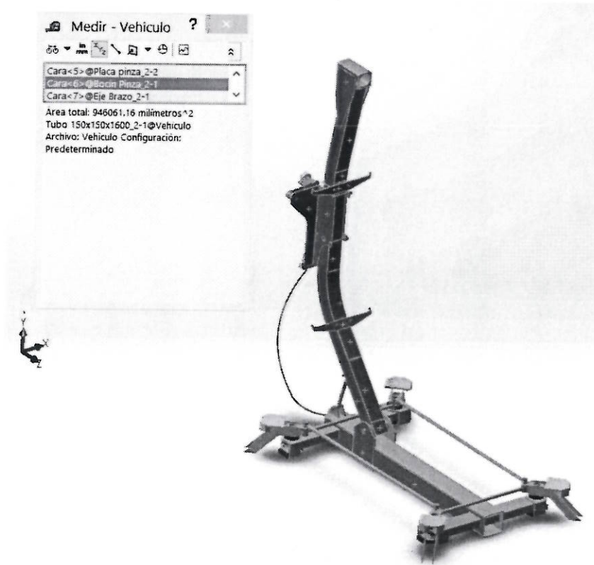
Figura VH- 15: Área de aplicación de F_v en el brazo de suspensión a 45^\circ . U: \text{mm}^2
