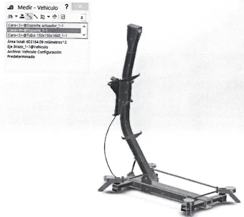
Figura VH- 14: Área de aplicación de F_v en el brazo de suspensión a 0^\circ U: \text{mm}^2
